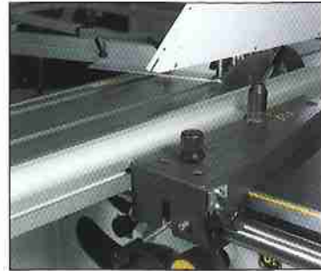
SOPORTE GUIA PARALELA EN FUNDICION CON GONIOMETRO DE MEDIDA Y DESPLAZAMIENTO RAPIDO Y ABATIBLE.
